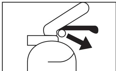
2. Hasicí přístroj pevně držte a zamiřte tryskou hadice na zdroj požáru (nikoliv do plamene).
