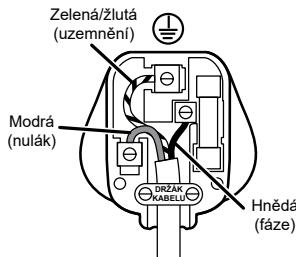
Ujistěte se, že vnější opláštění kabelu je pevně uchyceno v upevnění kabelu.
